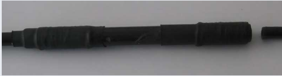
Carbon-Muffe in der Leichtbauweise mit Schnur-Wicklung und Schrumpfschlauch
