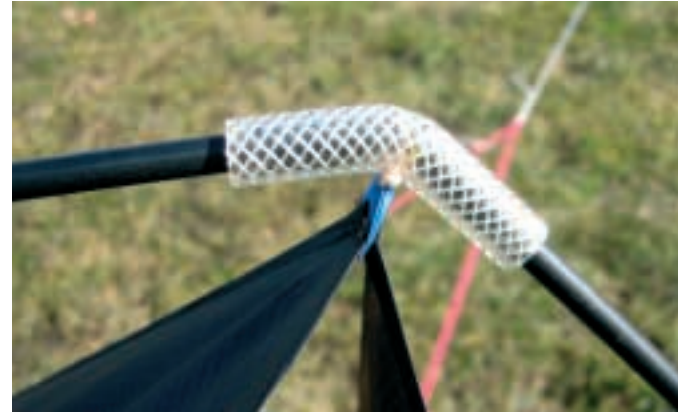
Zwei sich gegenüberliegende Segel werden zusammengefasst und mit einer Schlaufe versehen. Letztere wird mit dem Schlauchstück verbunden
